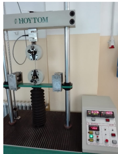
Figura 1. M.U.E. da marca Hoytom (10 kN).
